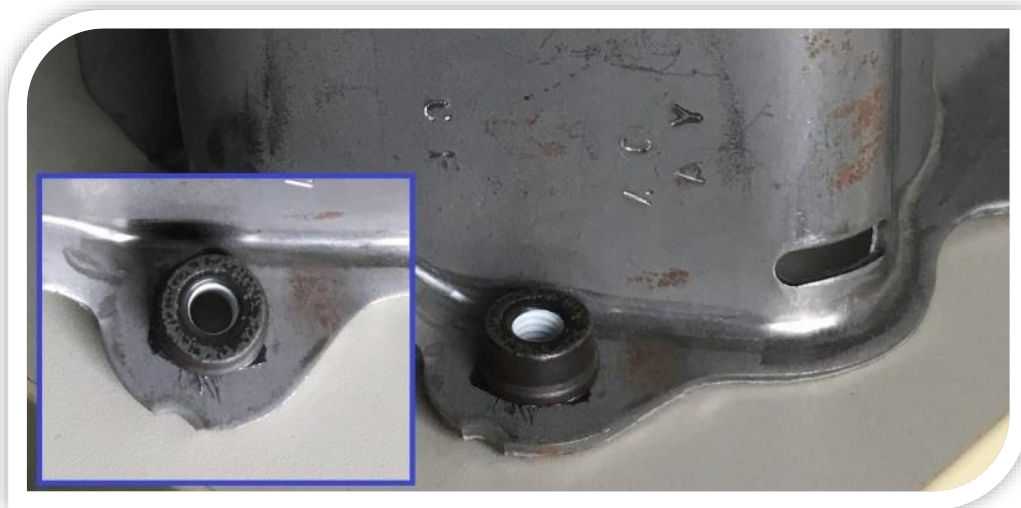
Bild 2: In der Beispielschweißaufgabe wird die Mutter unmittelbar neben einer Biegekante geschweißt.
