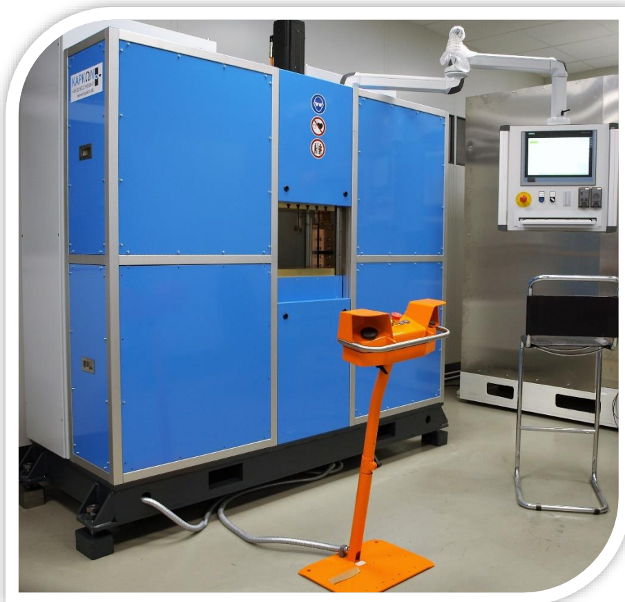
Bild A2: Portal-Maschine, die als Alternative für zusätzliche Schweißversuche eingesetzt wurde.
