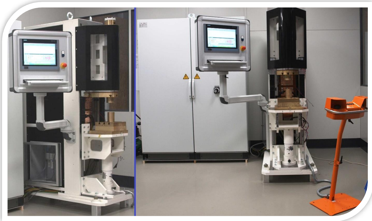
Bild A1: C-Gestell-Maschine, die als Standard für die Schweißversuche eingesetzt wird.
