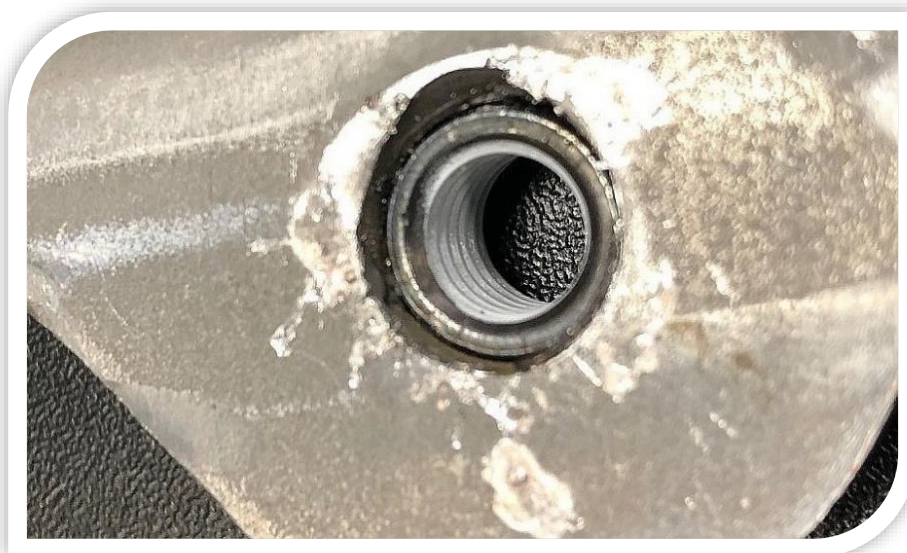
Bild 4: Verschweißte Mutter mit sauberer Mutternbasis und Schweißspuren auf der Unterseite des Bauteils.
