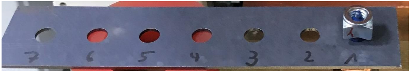
Abbildung 1: Blech aus 22MnB5+AS150 (markiert, mit Schweißmutter DIN 928 – M8 – St und Kegelstift)
