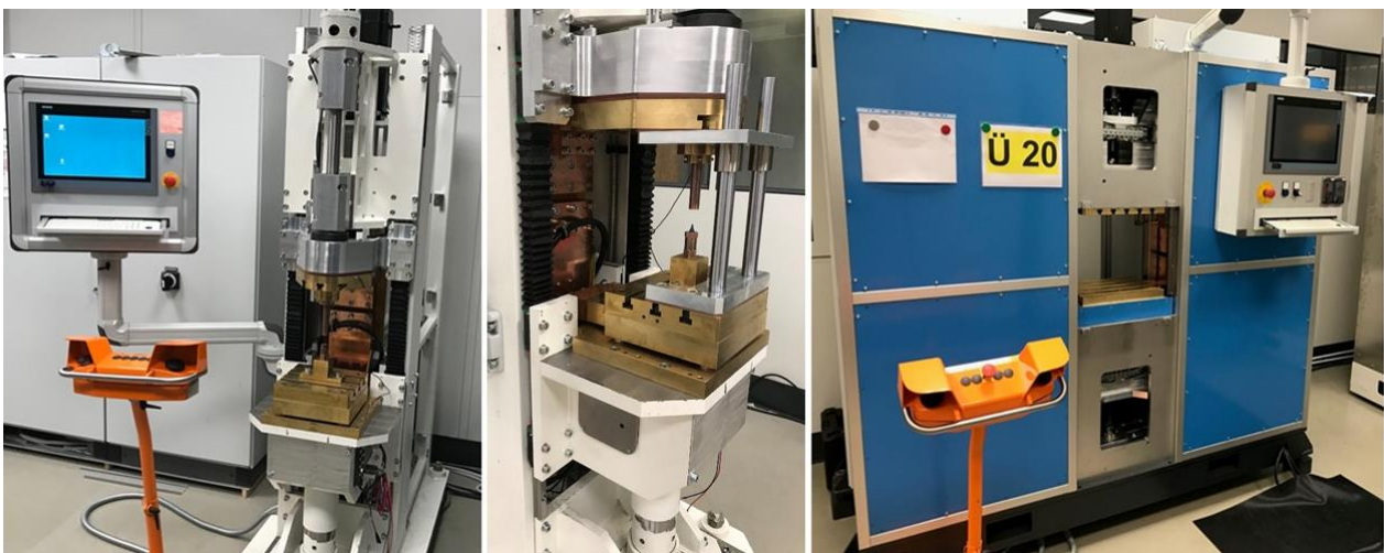
Abbildung 4: Versuchsanlage C-Gestell PrimKoM18 MCS (links), Säulenführung Maschinenversteifung C-Gestell PrimKoM18 MCS (mittig) und Portalrahmen PrimKoM P18 MCS (rechts)
